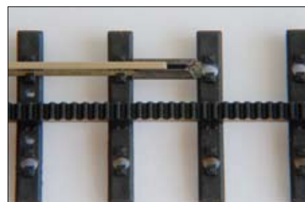
Das Anbringen der Schienenverbinder erfolgt am besten mit einer Pinzette oder feinen Spitzzange. Die Positionierung soll innerhalb des Schwellenrostteilstückes erfolgen und nicht an dessen Ende.
