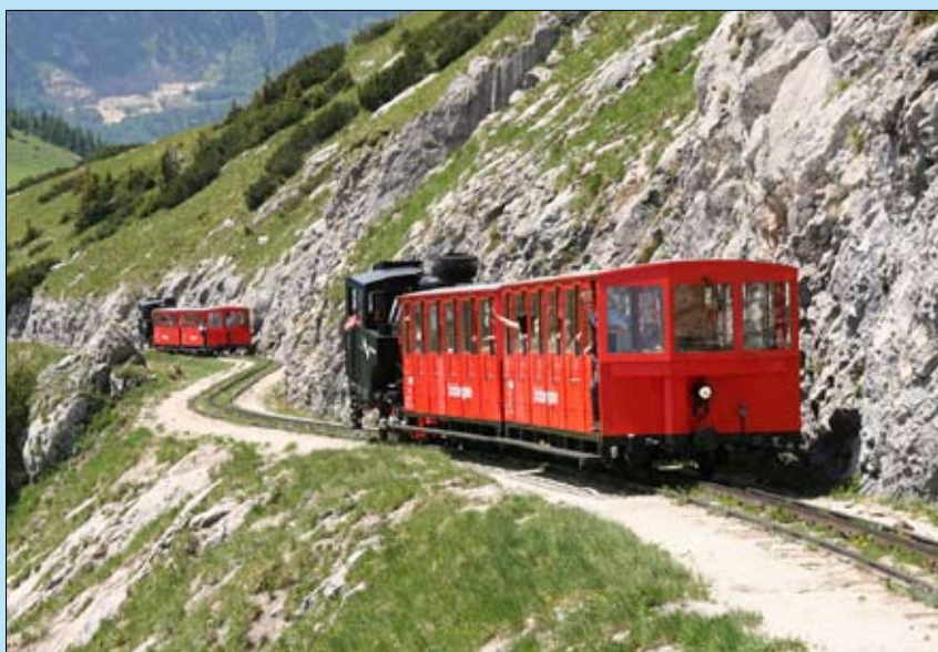
Zwei Neubaudampflokomotiven mit der Achsfolge C1 und Leichtölfeuerung im „signalfreien Blockabstand“ auf dem Weg zum Schafberg
